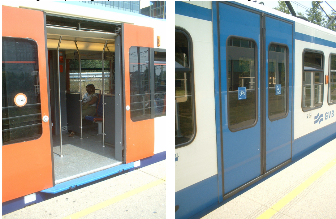
Afbeelding 4.2: oplossing klaptreden (links) versus perronverbreding (rechts).
